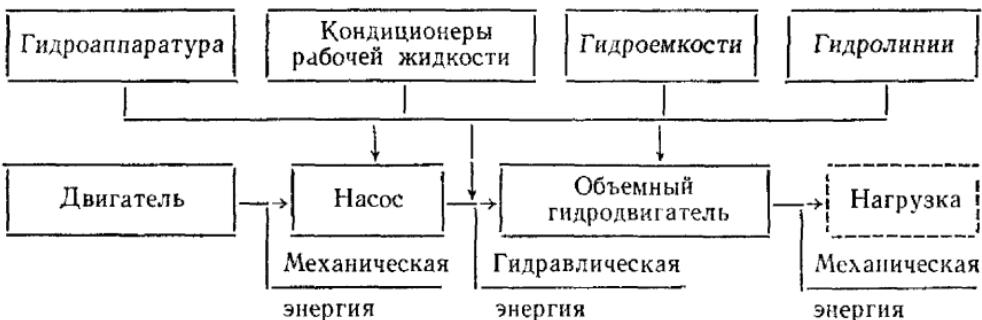
Рис. 1.1. Функциональная схема объемного гидропривода
