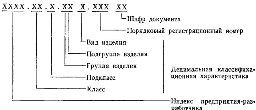
Рис. 3.1. Структура обозначения конструкторского документа
